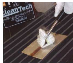
Reinigen der Schweißnaht
