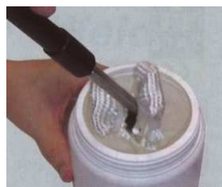
Eintauchen in die Reinigungslösung
